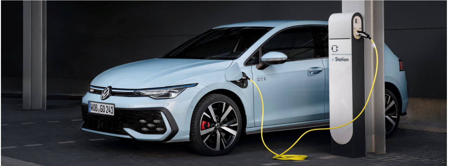
z.B. Golf GTE 1,5 l eHybrid OPF 130 kW (177 PS) / 85 kW (116 PS) 6-Gang Doppelkupplungsgetriebe DSG
